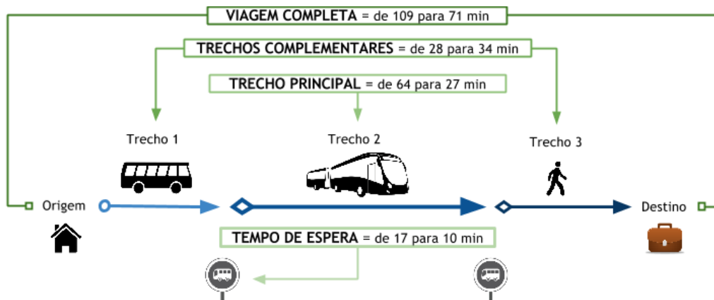
Figura 16. Esquema dos Tempos nos Trechos de uma Viagem Completa do Usuário Fonte: Elaborado por ITDP
