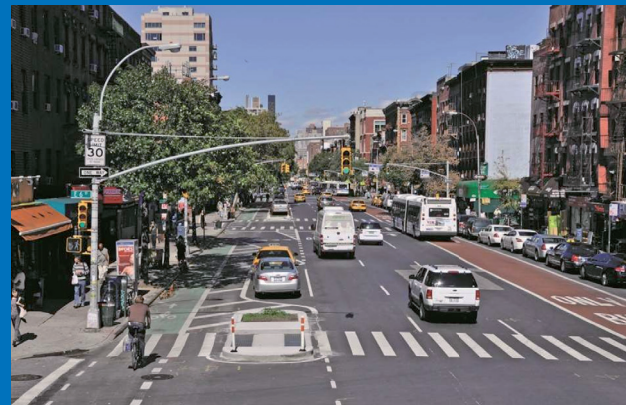
Via com limite de velocidade de 50 km/h (30 milhas/h) desenhada para proporcionar condições seguras para pedestres, ciclistas e condutores
