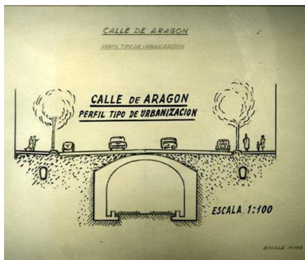
Fig. 306> Dibujo del perfil tipo de la calle Aragón (Dominguez. 1857. AFB)
