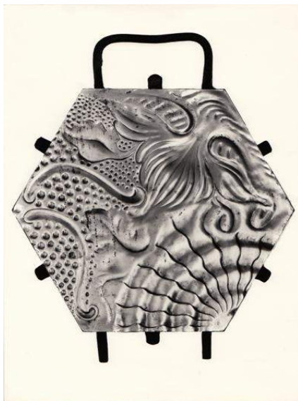
Fig. 352> Molde de acero del pavimento hidráulico de Antoni Gaudí (Arxiu Escofet)
