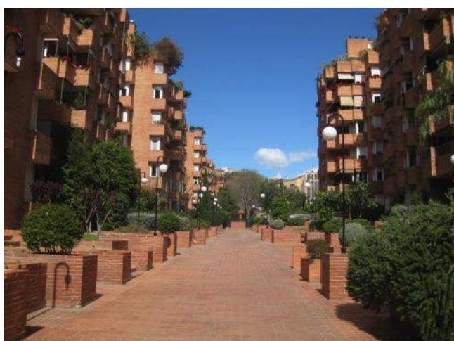
Fig. 419> Coderch (1968) conjunto de viviendas Les Cotxeres en Sarrià. El tocho es utilizado tanto para las fachadas como para la pavimentación del espacio entre edificios y la construcción de macetas, escaleras, etc.
