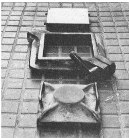
Fig. 155> Molde para la fabricación de las baldosas de cemento hidráulico (Rossell 1985, p.10)
