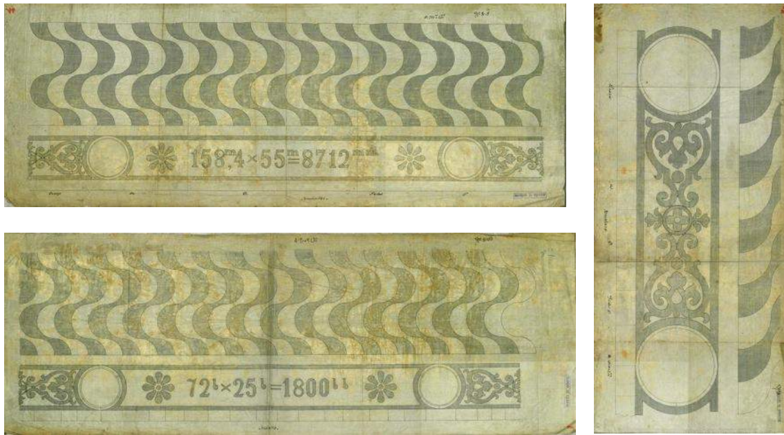
Fig. 487> Planos del empedrado mosaico para la plaza D. Pedro IV, la decoración de la cinta perimetral contiene las dimensiones de la plaza en metros y "brasses" (AMLSB-AC)
