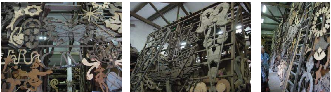
Fig. 478> Almacén municipal en el barrio de Alvalade donde se guardan los moldes de las calçadas mosaico para los trabajos de mantenimiento
