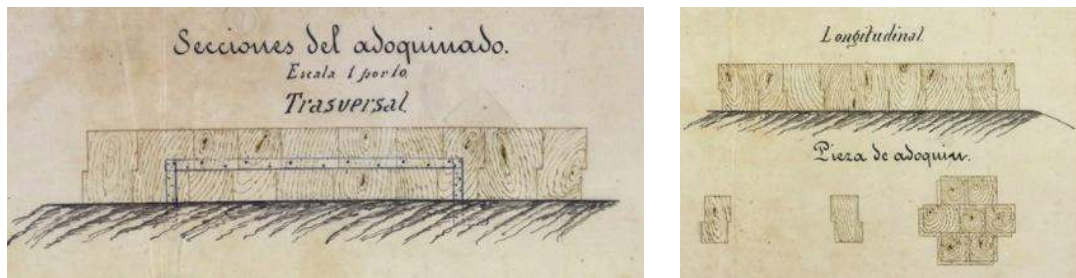
Fig. 92> Modelo presentado por Manuel Planas que utiliza estructura de hierro para fijar los adoquines (En AMCB 1885)
