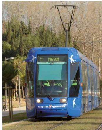
Figura 16 - Utilização de fios na impulsão do VLT na cidade de Montpellier, França.
