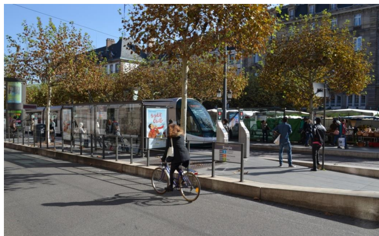
Figura 18 - Via segregada para o VLT. Estação com acesso facilitado por rampas. Estrasburgo, França.
