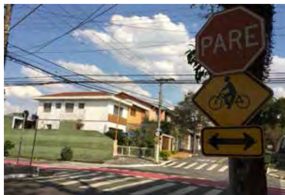
Placas A-30a e A-26a antecipadas em relação ao cruzamento e placa R-24a postecipada Av. Piassanguaba x R. Guatás, Zona Sul
