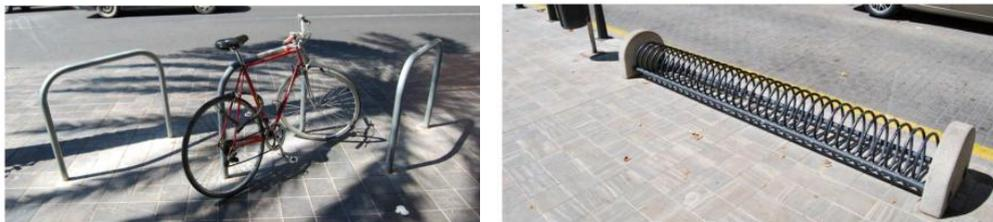
Ilustraciones 46 y 47: Tipos de soporte de estacionamiento (U-invertida y de rueda) de bicicletas.
