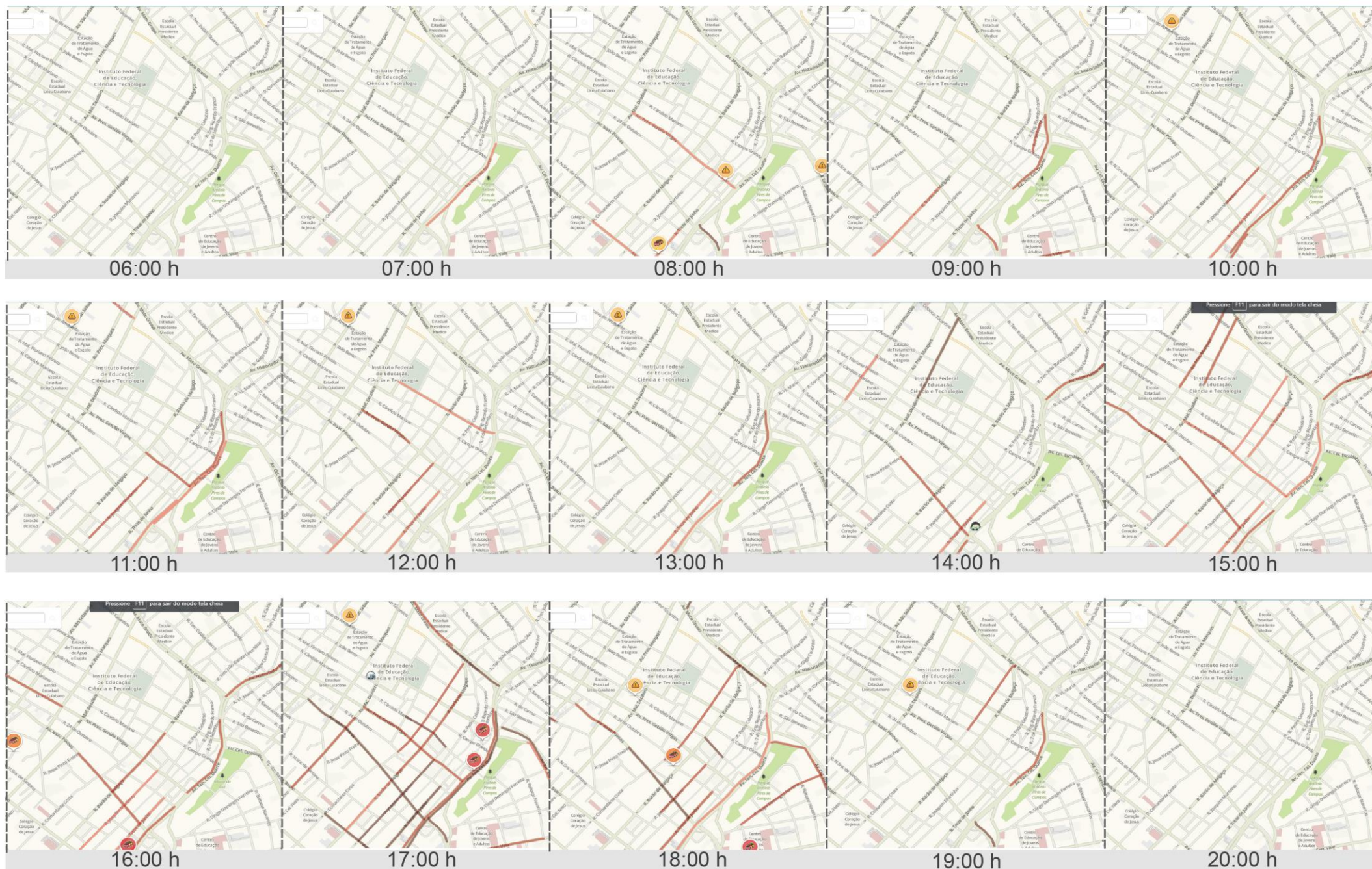
Figura 2 - Evolução do congestionamento no Bairro Centro Norte em Cuiabá Durante o dia
