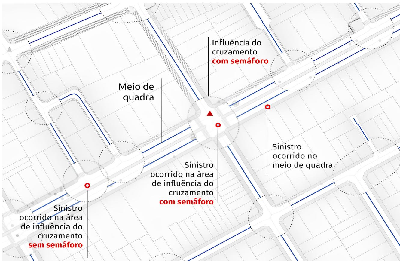
Figura 3: Divisão dos elementos estruturais da via em meio de quadra e cruzamento. Fonte: Instituto Cordial.
