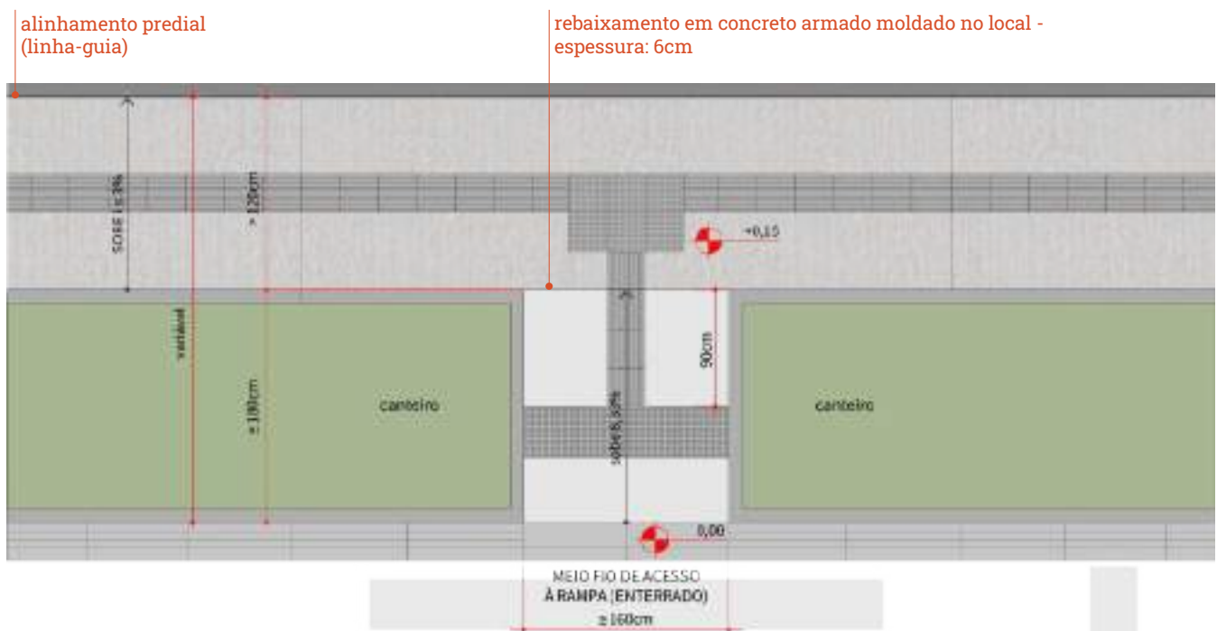
Rebaixamento em entre canteiros | Autoria: Ippuc DPR
