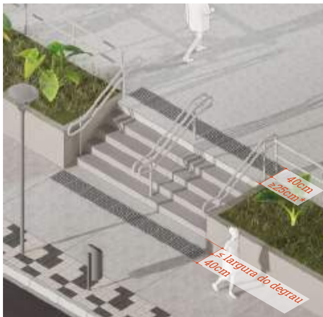
Piso tátil de alerta em escadarias Autoria: Ippuc DPR
