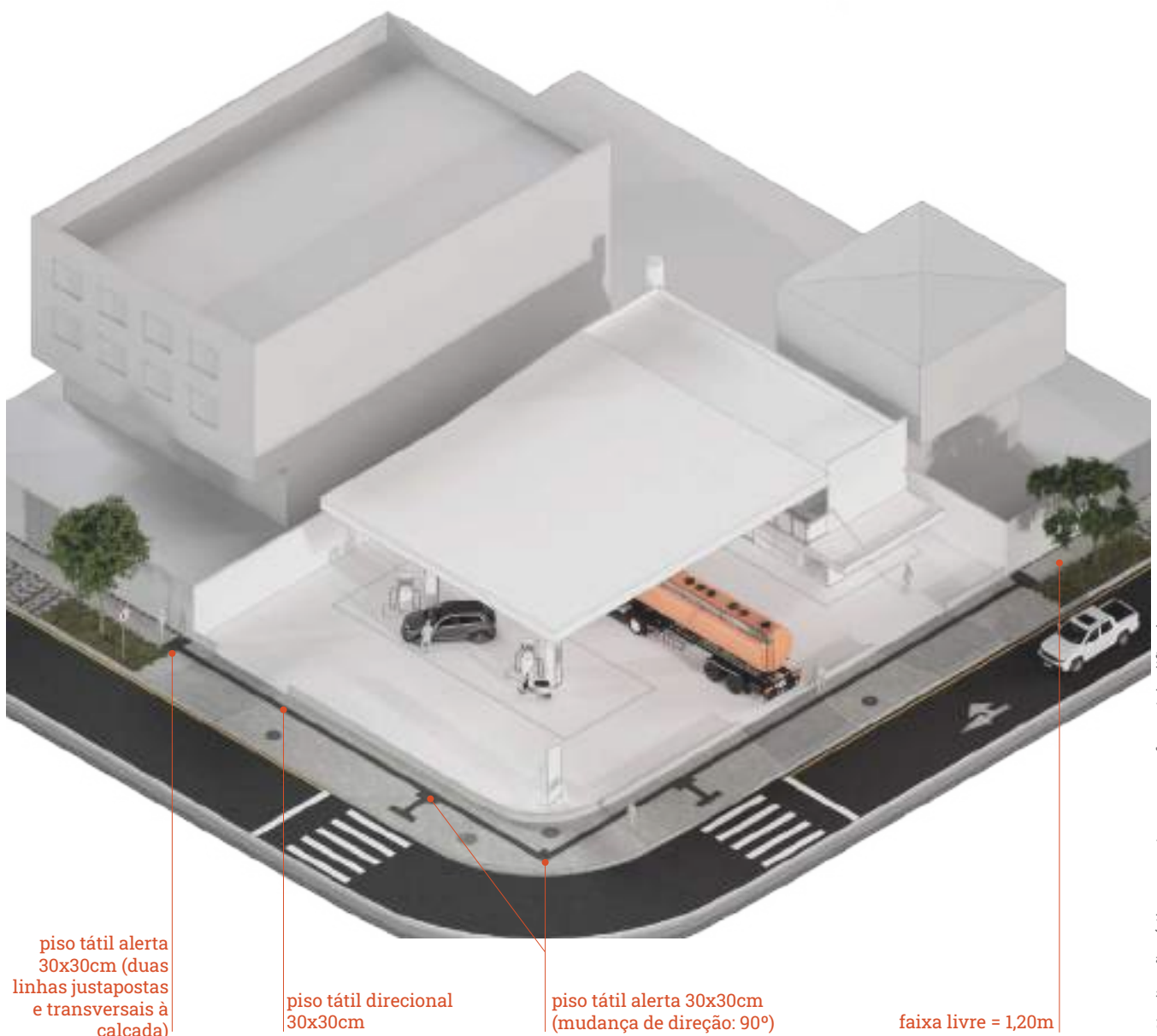
Simulação tátil nas esquinas, sem referencial edificado | Autoria: ippuc DPR
