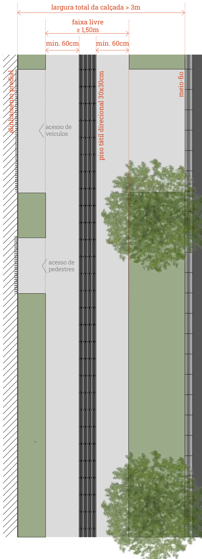
Sinalização tátil direcional no eixo da faixa livre | Autoria: Ippuc DPR
