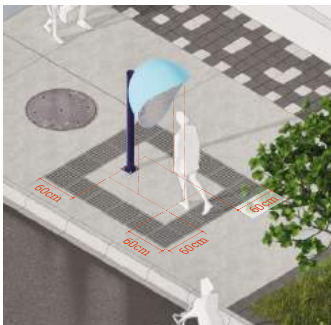
Piso tátil de alerta no entorno de obstáculos aéreos Autoria: Ippuc DPR
