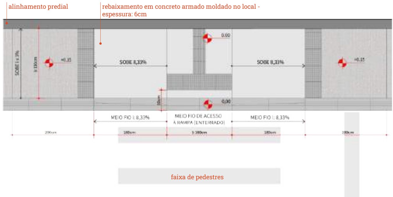
Rebaixamento em calçadas estreitas | Autoria: Ippuc DPR
