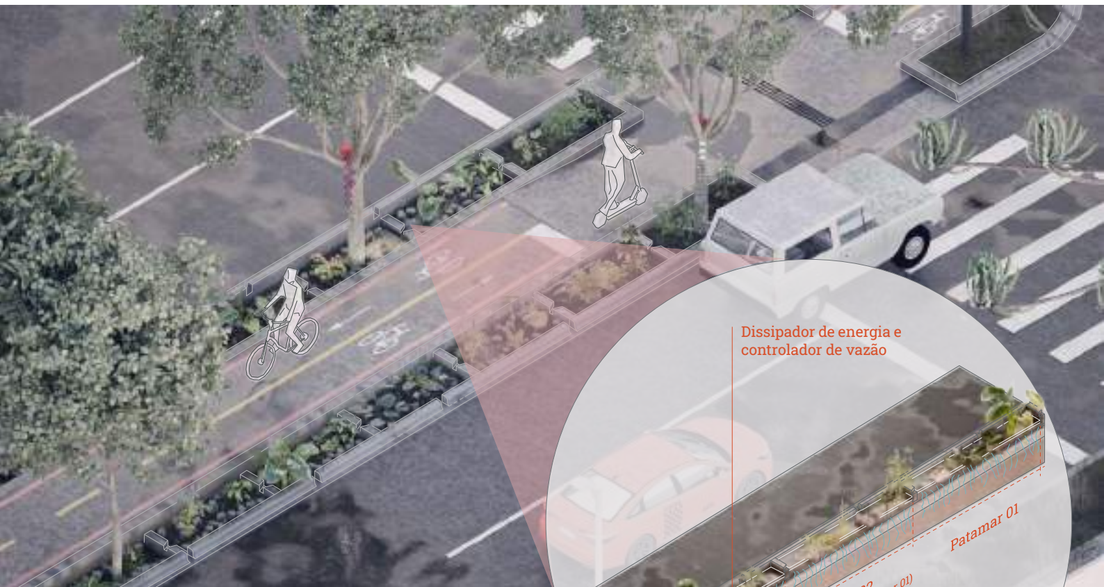
Biovaletas intercaladas com dissipadores de velocidade da água pluvial e controladores de vazão | Autoria: Ippuc DPR
