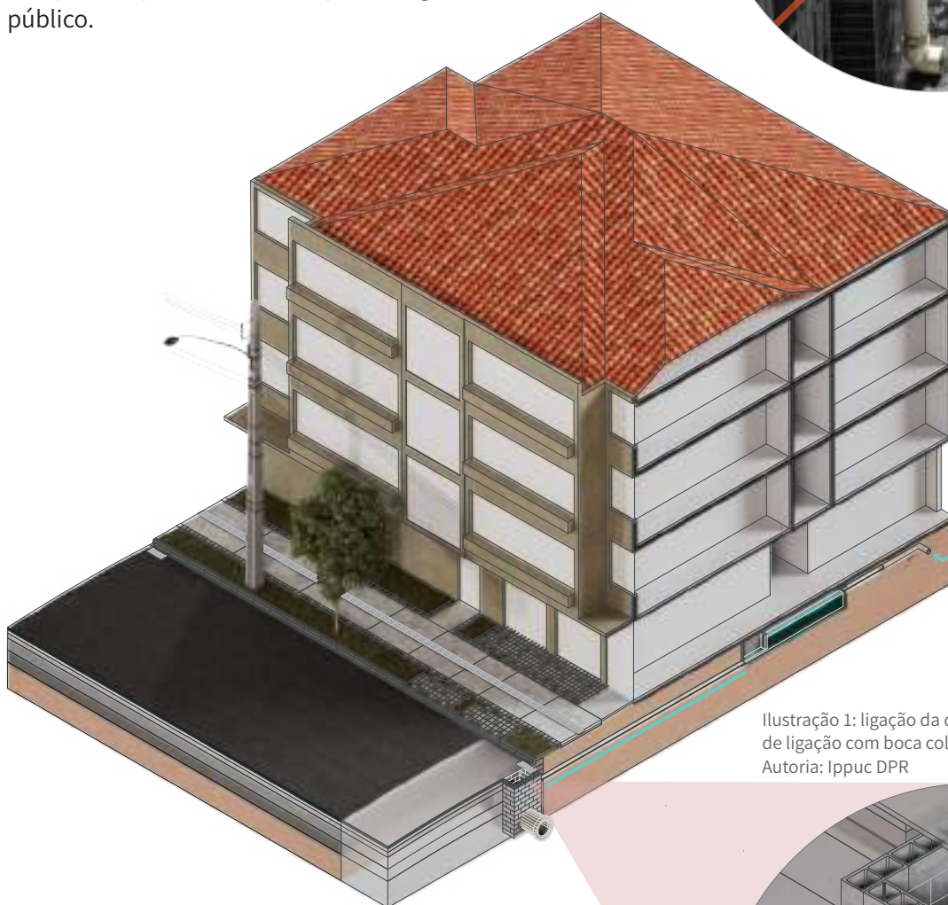
Situação inadequada: águas pluviais lançadas diretamente sobre a calçada Autoria: IPPUC DPR
