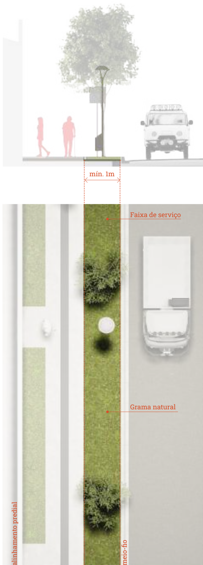
Faixa de serviço: planta e corte esquemáticos | Autoria: Ippuc DPR
