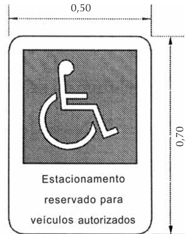
Fig. 88: Sinalização vertical em espaço interno
