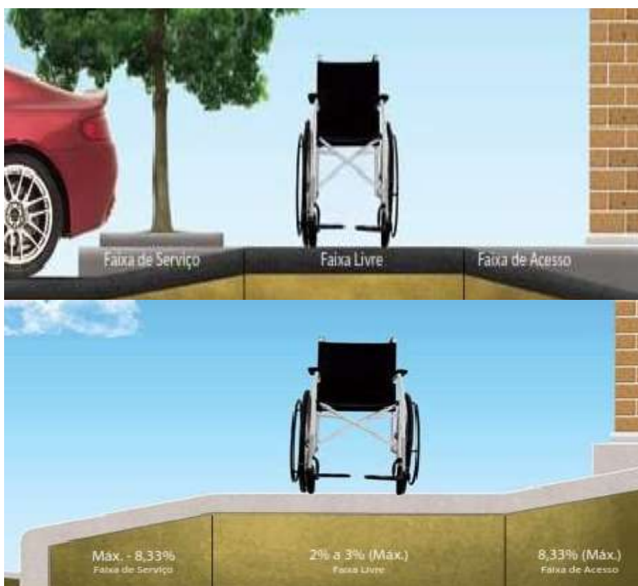
Figura 11 - Perfil correto para rebaixamento de entradas e saídas de veículos
