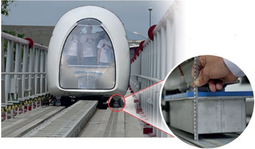
FIGURA 9 – MAGLEV COBRA operando, com destaque para o Criostato, que funciona como a roda para o modal
