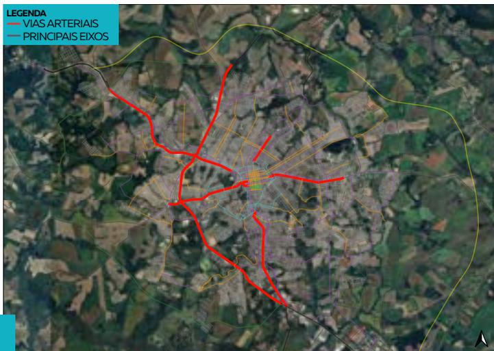
As Vias Arteriais possui a função de ligação entre bairros abriga os itinerários das principais linhas de transporte coletivo e absorve o tráfego de passagem, proporcionando ligações transversais e longitudinais em complementação a estruturação dos eixos.
