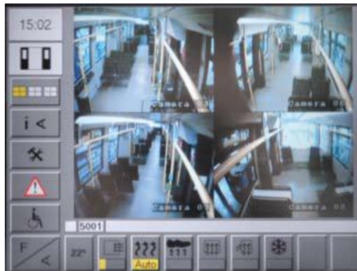
Figura 3-50: Exemplo de imagens das câmeras no interior do veículo
