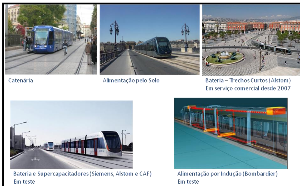
Figura 2.3.8 – Sistemas de alimentação de tração
